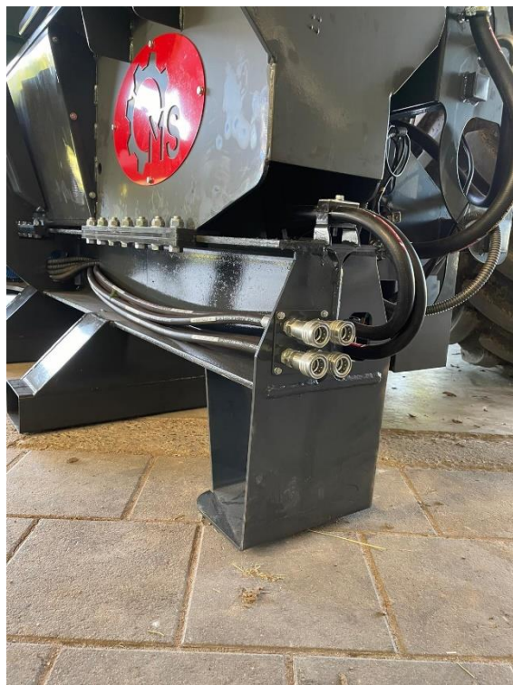
Deux circuits hydrauliques supplémentaires
