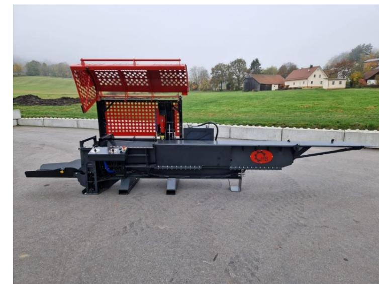
Table d'alimentation en acier massif se déplaçant grâce au vérin de fendage
